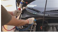
3. 车内冷媒冷冻油混合物被提取到视窗，关闭高压快接接头，取样完成；
