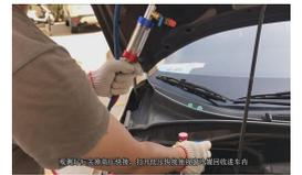
6. 观察直至视窗中冷媒冷冻油回收完毕，关闭连接到汽车端的低压快速接头。将汽车熄火，取下连接至汽车的高低压快速接头。
