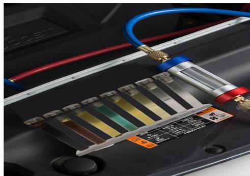
**A. 状态：**理想情况下的制冷剂和润滑剂的混合物，无色，透明，溶解性好。
