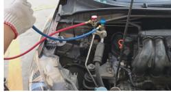
2. 启动汽车，打开已连接到汽车端的高压快接开关；
